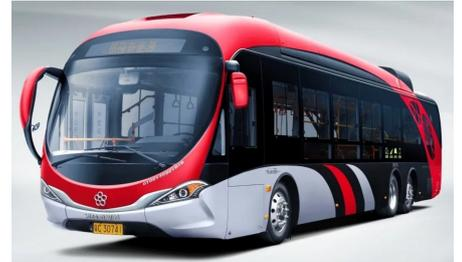
Der Dolphin von Yinlong wird mit einer LTO-Batterie mit einer Kapazität bis 150 kWh ausgerüstet. Gemäss Hersteller lässt sich die Batterie in 20 Minuten laden, wobei bis 30000 Zyklen möglich sein sollen.
