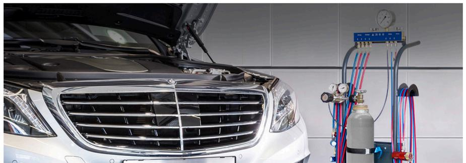
Auch für Klimaanlagegekühlte Hochvolt-Batterien gibt es Prüfmöglichkeiten. Vor dem Einbau wird mittels eines Prüfgases die Dichtheit des Batterieverdampfers kontrolliert.
